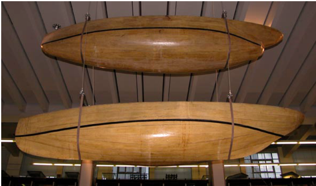
Fig. 1 Los cascos de Swan (arriba) y Raven (abajo) en exposición en el Museo de Ciencias de Londres. Estos modelos fueron contruidos por Froude con el fin de establecer leyes de resistencia y escala aplicables al diseño de los cascos de los barcos.
