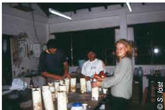
42 Trabajo en el laboratorio de la ECSF: los cilindros blancos se llenan con tierra y luego son ubicados en el suelo en el área de estudio. Sirven para medir la respiración del suelo y la concentración de distintos nutrientes en el agua que llega al suelo.
